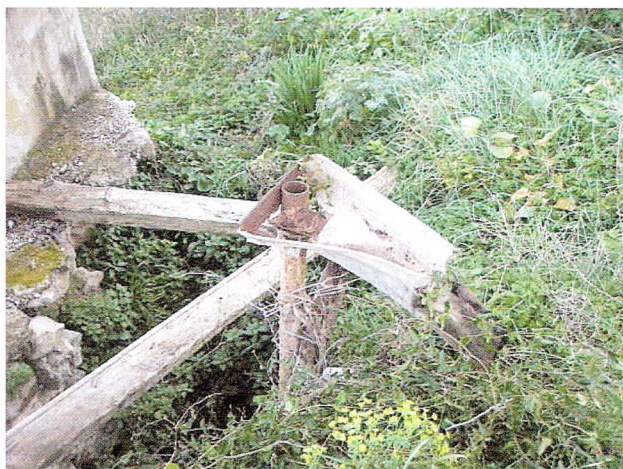
Fig. 9: Tub i pastera pels quals pujava l'aigua en una sènia de rosari (restes d'una altra de les sènies de Feliu).
