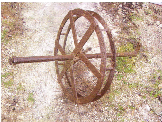
Fig. 11: Roda d'eix horitzontal (de manovella), de l'antiga sènia de rosari de Coletto, al barranc de Paratella.
