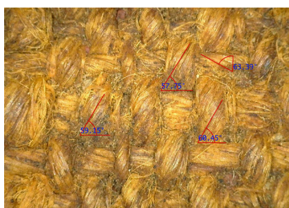
Imagen 18: Ángulo de torsión del hilo. Fotografía realizada con el microscopio digital USB Dino-Lite Special Lighting, x55.
