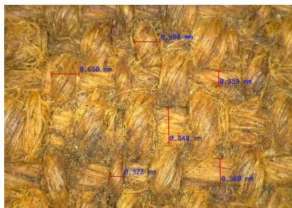
Imagen 16: Grosor de los hilos. Fotografía realizada con el microscopio digital USB Dino-Lite Special Lighting, x55.
