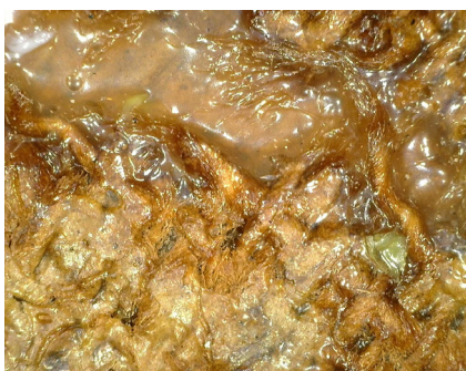
Imagen 38: Fotografía de detalle del adhesivo del parche en el reverso de la obra, realizada con el microscopio digital USB Dino-Lite Special Lighting, x55.
