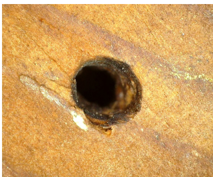
Imagen 33: Fotografía de detalle del orificio provocado por los agentes xilófagos, realizada con el microscopio digital USB Dino-Lite Special Lighting, x55.
