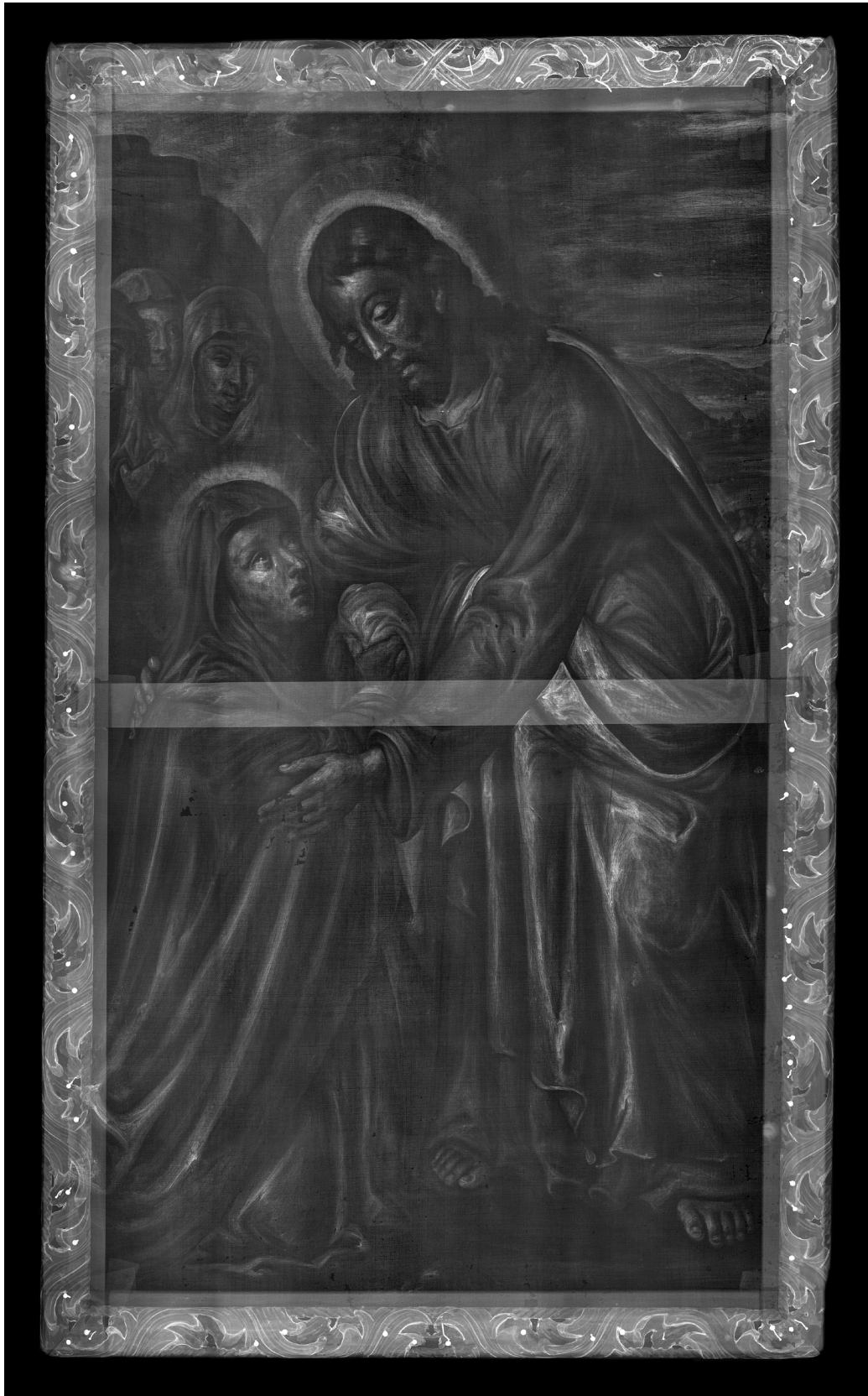
Imagen 23: Fotografía general de la obra realizada con rayos X.
