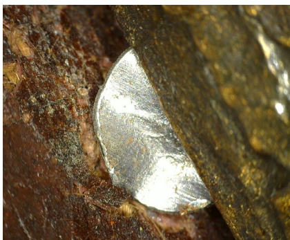
Imagen 14: Detalle de los clavos actuales que sostienen el soporte textil. Fotografía realizada con el microscopio digital USB Dino-Lite Special Lighting, x55.
