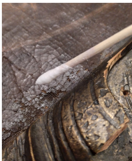
Imagen 59: Fotografía de detalle de hisopo en la realización de las pruebas de solubilidad.
