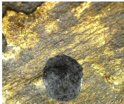
Imagen 52: Detalle de las manchas de origen desconocido. Fotografía realizada con el microscopio digital USB Dino-Lite Special Lighting, x55.
