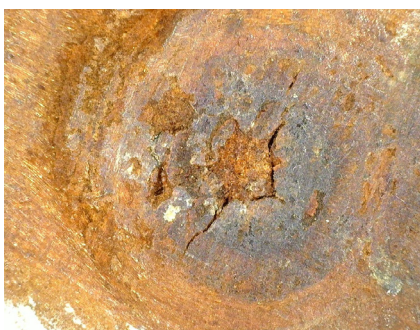
Imagen 34: Fotografía de detalle de un nudo, realizada con el microscopio digital USB Dino-Lite Special Lighting, x55.
